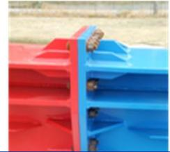
研究目的: 突出構造から突出の無い構造にするために、リブ配置・形状ボルト配置に着目した連結部の構造最適化について検討する。
