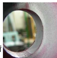
亀裂進展の例(染色浸透探傷検査)
