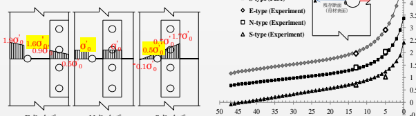
付加曲げによる補修後の欠損断面応力分布
