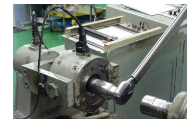
締付け試験状況
