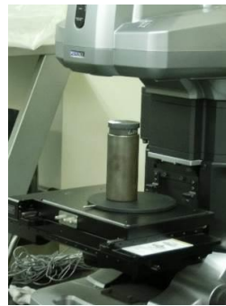
残留変位計測状況
