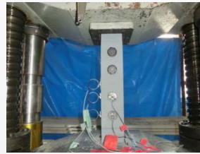
図-3 すべり試験の実施状況
